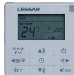
Пульт управления проводной сенсорный. Позволяет задавать режимы работы фанкойла, устанавливать время включения и отключения, регулировать направление жалюзи (для моделей с регулируемыми жалюзи). Содержит приемник ИК-сигналов беспроводного пульта управления LZ-KNP. Применяется для управления канальными фанкойлами – совместно (входит в комплект поставки) с LZ-FMM22.1 и LZ-FMM42.1.
