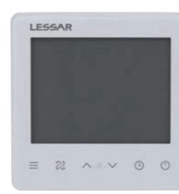
Проводной пульт управления сенсорный для управления канальными фанкойлами по Modbus RTU. Максимальное количество подключаемых фанкойлов по Modbus RTU – 32 шт. LZ-UQPG2 применяется для управления канальными фанкойлами серий LSF-...DS22L, LSF-...DS22, LSF-...DS22H, LSF-...DS42L, LSF-...DS42, LSF-...DS42H.
