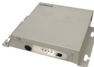
Блок управления (система группового управления) предназначен для организации управления работой фанкойлов с проводного пульта управления LZ-KNP, также необходим для подключения фанкойлов к системе централизованного управления с центрального пульта LZ-UPW7. Блок управления LZ-FMM42.1 имеет встроенный шлюз для подключения фанкойлов к системе BMS по сетевому протоколу Modbus RTU.
